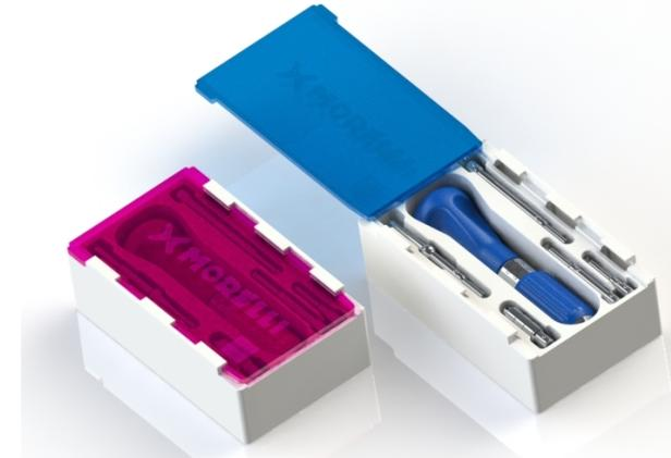
El **“Kit de herramientas”**\* consta de una llave manual con puntas intercambiables que se fijan a la parte hexagonal de la cabeza del minitornillo, lo que permite instalarlo o retirarlo adecuadamente. Las Puntas Intercambiables, además de permitir el montaje en la Llave Manual, cuentan con un encaje estándar para instalar el Mini Tornillo mediante un contraángulo quirúrgico.
