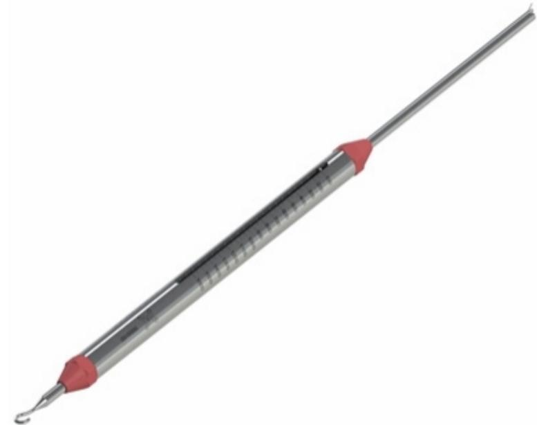
São instrumentos destinados à medição de forças simples geradas pela mecânica ortodôntica.
